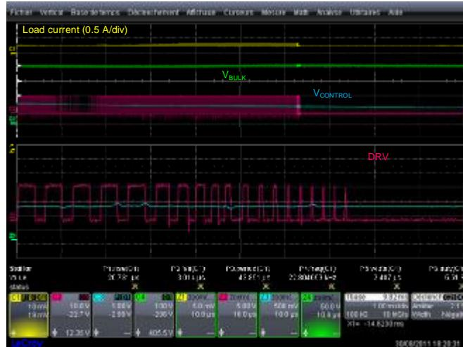
输入欠压检测，提供“软”停止
